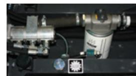
Réservoir d'huile hydraulique incorporé au châssis
