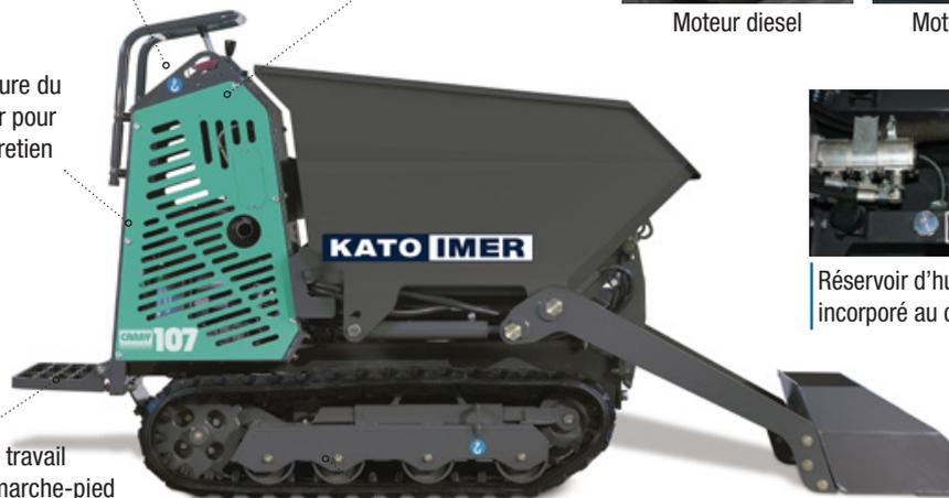
Équipé de 3 pompes qui permettent une utilisation indépendante du déchargement de la benne et de la pelle chargeuse de la traction
